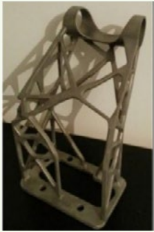
Şekil 2: Topoloji optimizasyonu uygulanmış ve EBM prosesi ile üretilmiş uydu anteni destek parçası [1]
