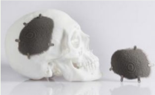
Şekil 3: EOSINT M 280 tezgahında üretilmiş Kraniyal implant [1]
